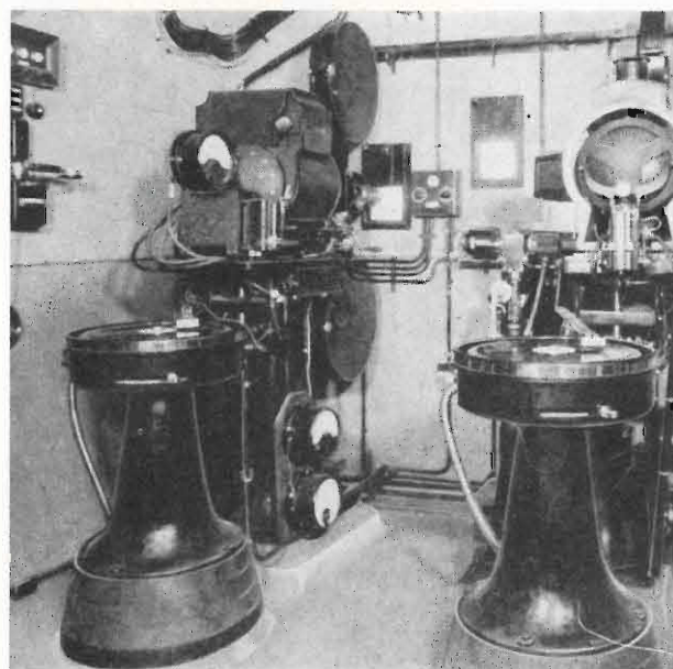
Fig. 5 - Proiettore cinematografico in cabina (1929). Il suono veniva registrato su dei dischi fonografici forniti insieme alla pellicola.
